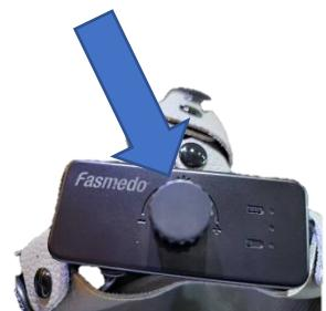
B. LED 燈：旋轉旋鈕開關可調整 LED 燈的亮度，
